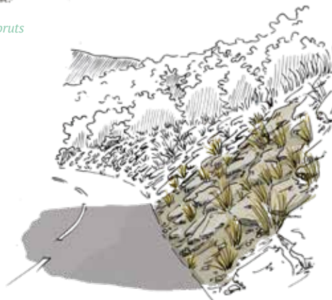
Talus stabilisé en pierre et végétalisé
